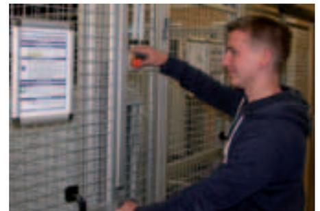
Abbildung 1: Sicherheitskäfig mit ausgehangener Betriebsanweisung, Notschaltereinheit und Gehörschutz
