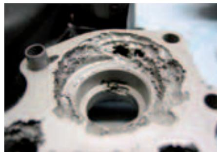
Galvanische Korrosion am Wasserpumpengehäuse
